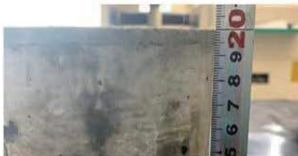
▲ローラーストーン施工試験体 厚み
