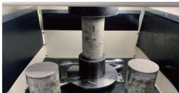
▲圧縮強度検証の様子(拡大)
